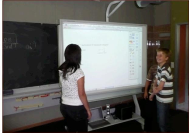
Il est donc possible d'effectuer à la main ou à l'aide d'un stylet (selon le modèle), tout ce qui est possible de réaliser à l'aide d'une souris, sur un format d'écran assez important (jusqu'à plus de 2m de diagonale). En règle générale, le tableau est fourni avec un logiciel dédié, qui permet de tirer parti des possibilités nouvelles de cette technologie.
